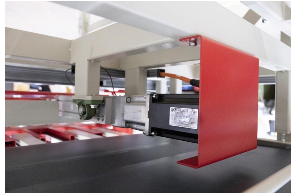
Links KOLLMORGEN kompakter und leistungsstarker Controller PCMM und Servoverstärker AKD. Rechts der beschleunigungs- starke Servomotor AKM.
